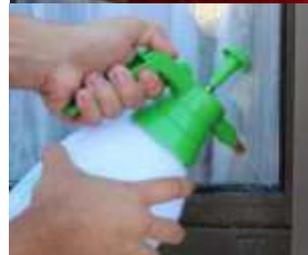
**Empfohlene Werkzeuge:** Sprühflasche mit Benetzungslösung (ein Liter Leitungswasser und vier Tropfen tensidfreie Seife), Glasreinigungsschaber, Cutter, robuster 6-Zoll Sicherheitsfolien-Rakel, Papiertücher.
