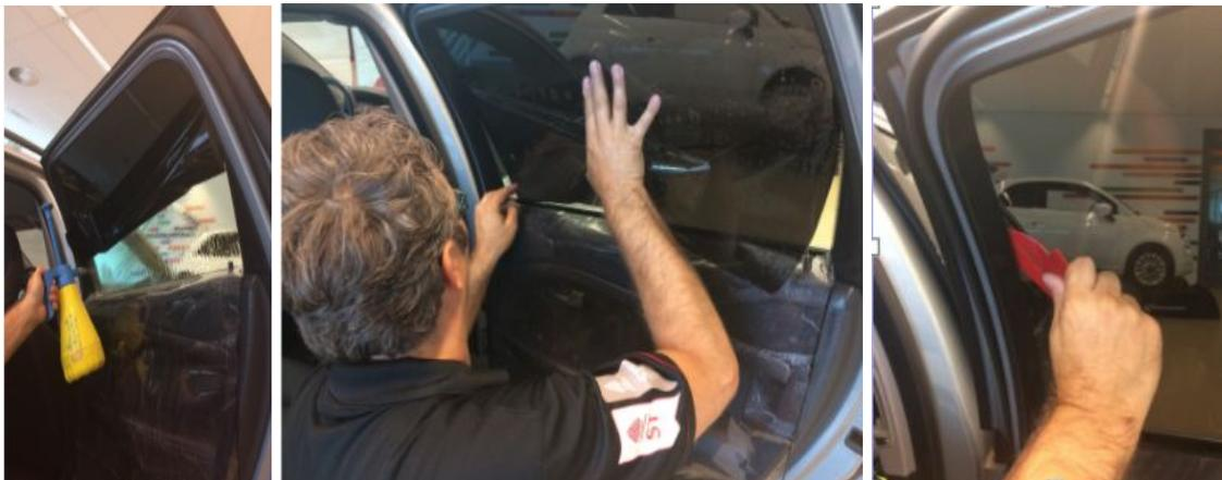
Liegt die Folie wie gewünscht, befeuchten Sie die Oberfläche nochmals und üben Sie mit dem Raker gleichmäßig Druck aus, um den Klebstoff zu aktivieren und die Folie gut zu fixieren. Dabei wird überschüssiges Wasser auf der Klebstoffseite herausgepresst.
