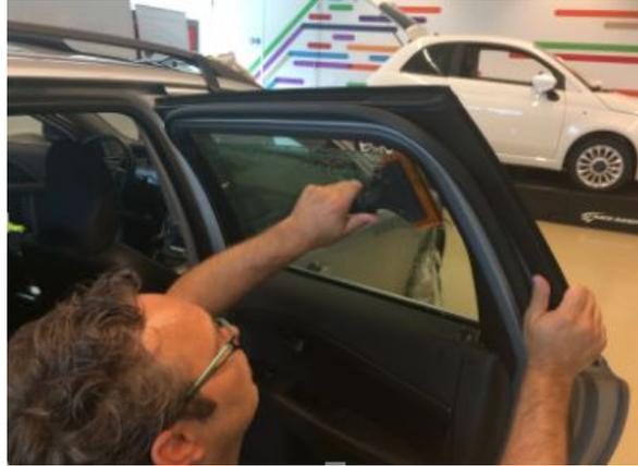
Positionieren Sie die Folie auf der Innenseite des Fensters und legen Sie die Oberkante der Folie dabei genau auf die obere Kante des Fensters. Achten Sie darauf, dass die Glasinnenseite und die Klebstoffseite genügend feucht ist, um die Folie leicht verschieben bzw. positionieren zu können. Arbeiten Sie in dieser Phase besonders sauber und sorgfältig, um auf der Folienoberfläche jegliche Faltenbildung zu verhindern.
