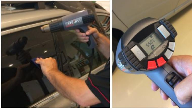
Beim Erwärmen erscheinen kleine Tunnel/Kanäle auf dem Material. Streichen Sie sie vorsichtig von innen nach außen aus der Folie. Sollten sich größere Rillen bilden, teilen Sie sie mit dem Rakel in kleinere Bereiche und streichen Sie sie wie beschrieben aus. Schrumpfen Sie unbedingt die gesamte Oberfläche der Folie und beseitigen Sie alle Rillen wie beschrieben.
