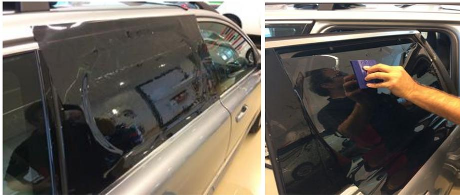
Danach wird die Folie mit einer Heißluftpistole genau auf Fenstergröße geschrumpft.
