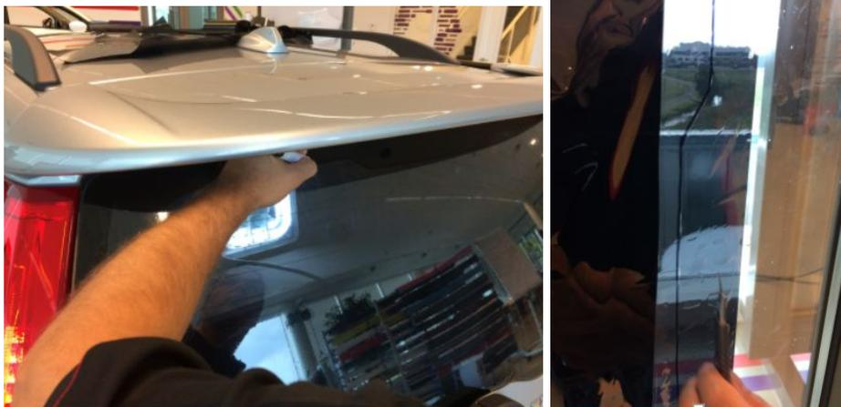
Nach dem Zuschnitt der Folie reinigen und befeuchten Sie die Innenseite der Heckscheibe mit reichlich Seifenwasser, um das Material zu positionieren. Schützen Sie dabei den Innenraum des Wagens.
