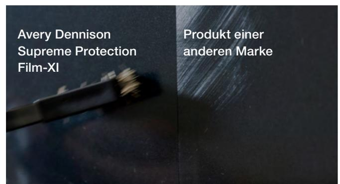
Die selbstregenerierende Folie lässt Kratzer bei Raumtemperatur innerhalb von Minuten verschwinden.
